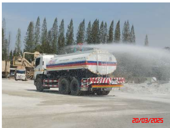
รูปที่ 10 การฉีดพรมน้ำเส้นทางขนส่งแร่
